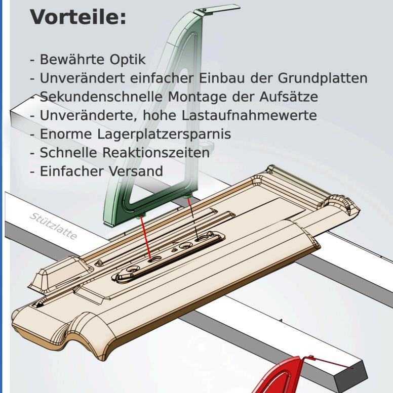
**Einlicken** der Aufsätze in den Adapter der Metallgrundplatte **sekundenschnell** und ohne Werkzeug, perfekte Verriegelung durch den integrierten Sicherungsbolzen
